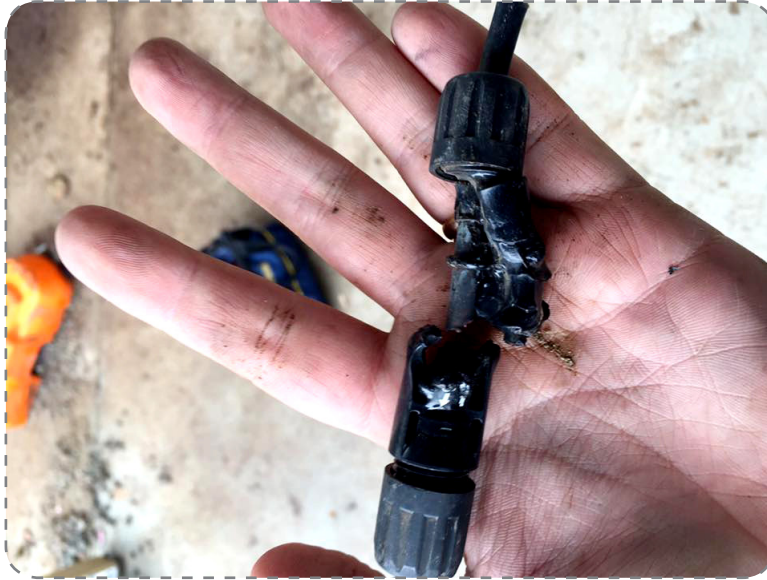
الشكل (6): تلف موصلة MC4 للألواح الشمسية
